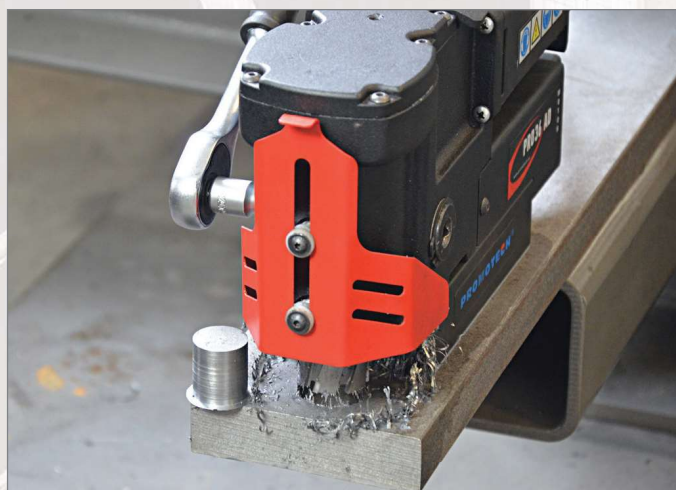
Wiercenie frezami trepanacyjnymi
