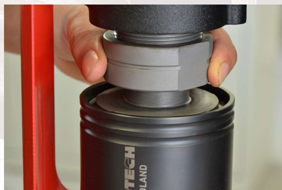
Oprawka do gwintowania zabezpieczona nakrętką
