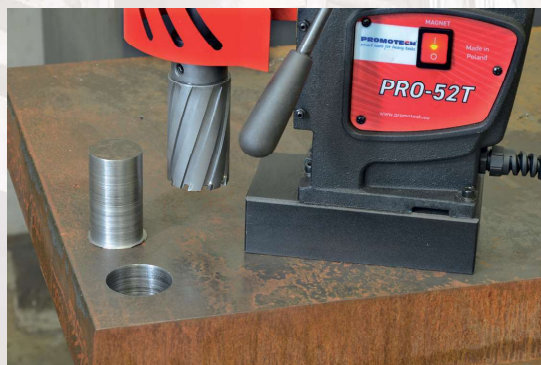
Wiercenie frezem na głębokość 75 mm
