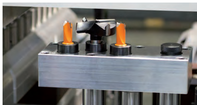
Głowica CMT334-4595 może być używana na wiertarkach wielowrzecionowych.
