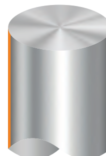
Chropowatość trzpienia Ra \leq 0,3 \mu m
