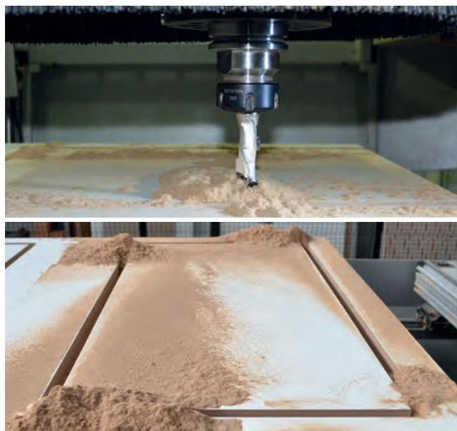
Praca bez użycia odciągu pyłu
