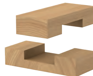
Połączenie pod kątem prostym
