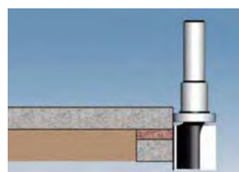
Wyrównywanie elementów wykonanych z materiałów o różnych grubościach.
