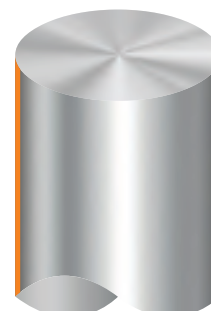
Chropowatość trzpienia Ra \leq 0,3 \mu m
