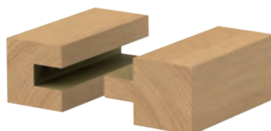
Połączenie na pióro-wpust
